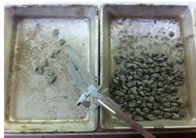
Определение количества плоских и удлиненных зерен в соотношении 5:1
