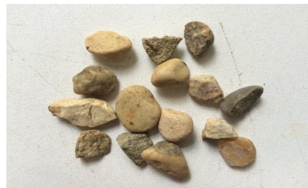
Определение количества дробленых зерен с одной и с двумя и более дроблеными поверхностями
