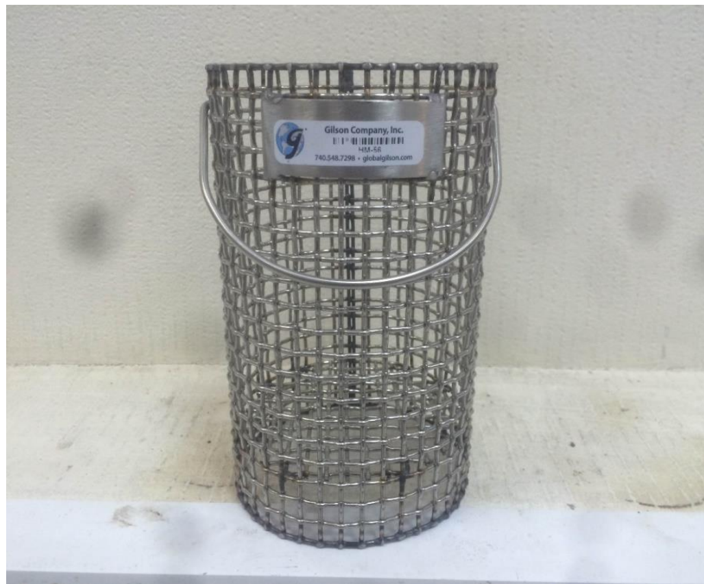
Корзина с размером ячеек 6,3 мм для определения стекания вяжущего
